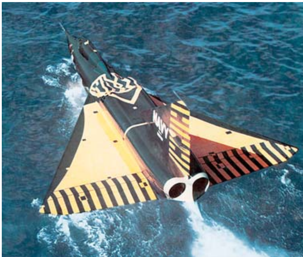
"Си Дарт" — попытка создания сверхзвукового гидросамолета.
