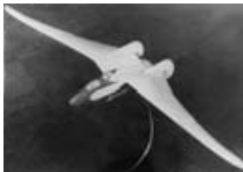
Модель бесхвостого планера В.Н.Беляева БП-3.
