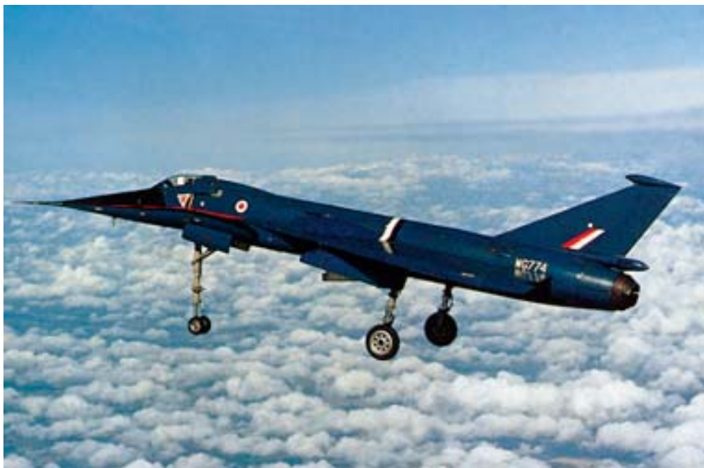
ВАС.221 — второй экспериментальный прототип сверхзвукового пассажирского самолета.
