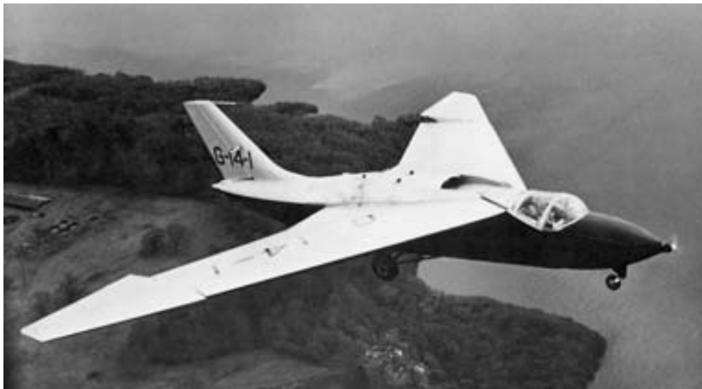
Шорт "Шерна" с изоклиническим крылом.
