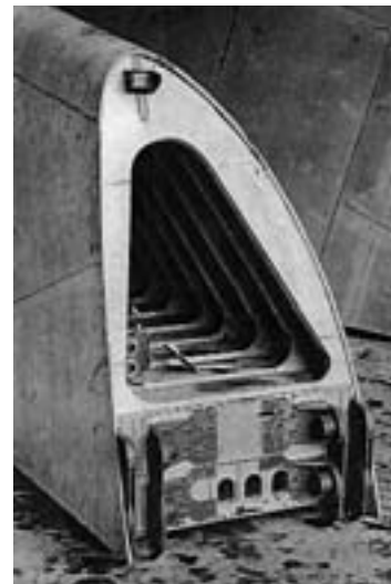
Передняя часть крыла недостроенного гиганта No.VIII.
