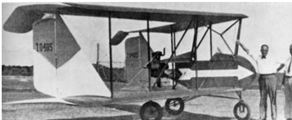
"Эрроухед" — попытка воплощения идей Данна и Берджеса в конструкции "массового" самолета 30-х годов.
