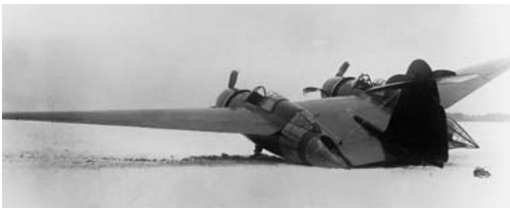
ДБ-ЛК после аварии, случившейся при пробной пробежке по аэродрому.
