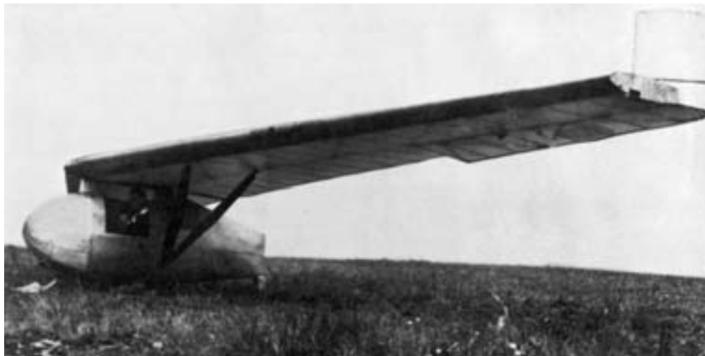
Планер "Шторх-II". Аппарат страдал плохой путевой устойчивостью.
