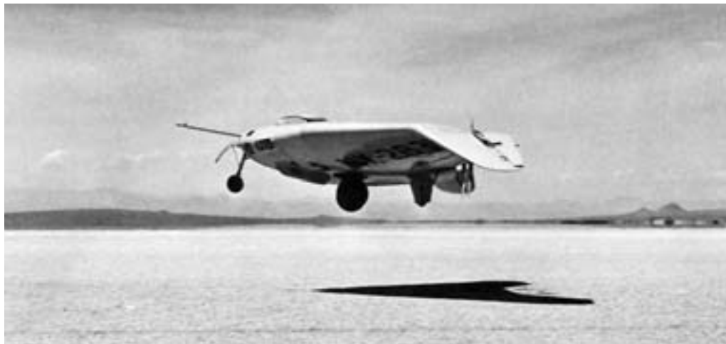
Из-за недостаточной мощности двигателей "Лайкоминг" N-1M мог летать только у самой земли.
