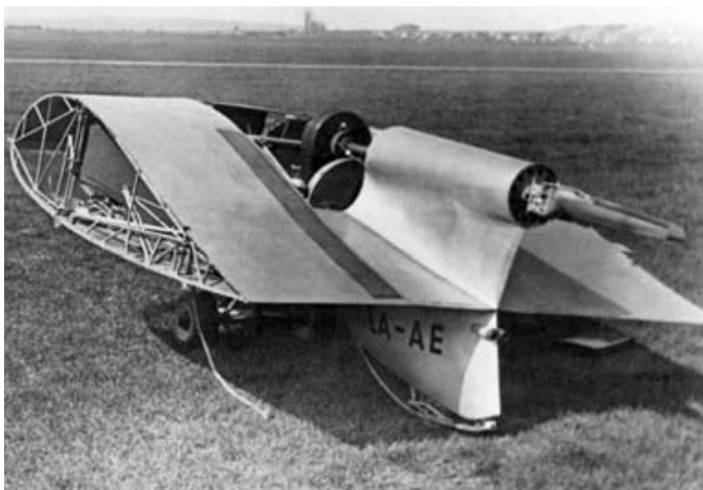
Центроплан Но.III с установленным на нем двигателем. Чтобы не ухудшать аэродинамические характеристики аппарата при неработающем двигателе, лопасти винта, как показано на фотографии, могли складываться.
