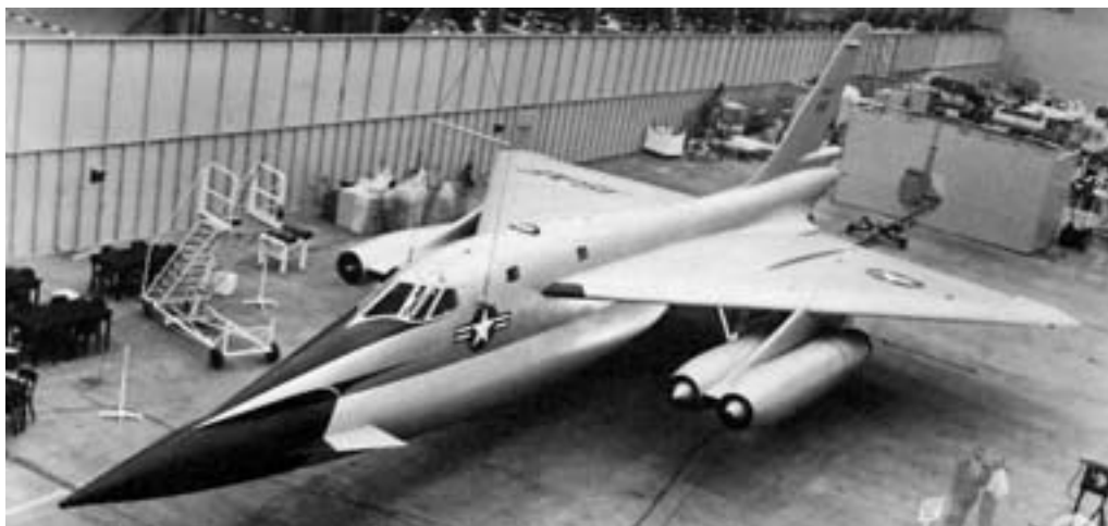
Полноразмерный макет первого варианта бомбардировщика В-58 (1952 г.).
