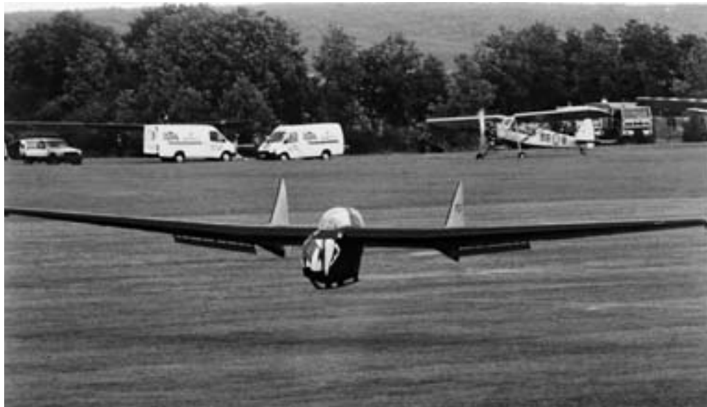
Планер AV-36 — одна из немногих спортивных серийных "бесхвосток".
