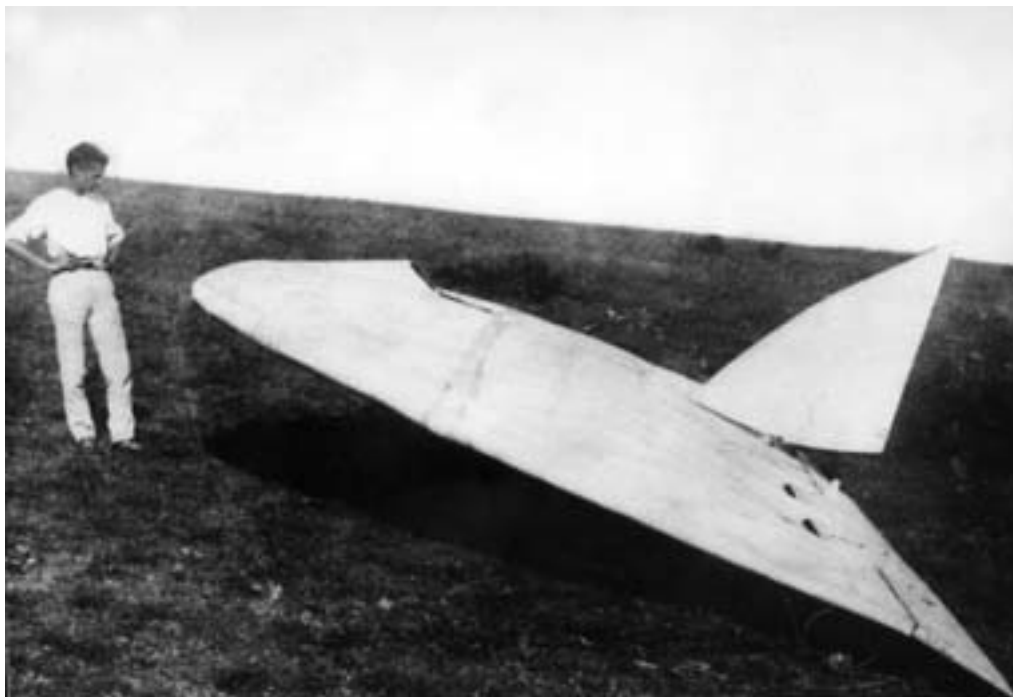
Планер БИЧ-2 имел увеличенный размах крыла и вертикальное оперение.
