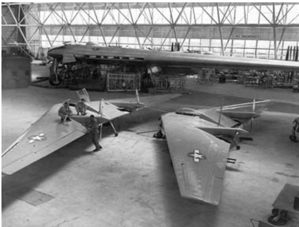
Экспериментальные N-9M в ангаре около строящегося бомбардировщика XB-35.
