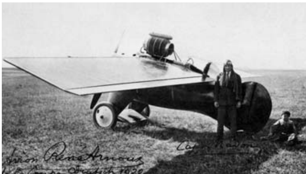
Ж.Мэдон около гоночного моноплана Арну. Недостатком самолета был плохой обзор из кабины из-за расположенного впереди большого бочкообразного радиатора.
