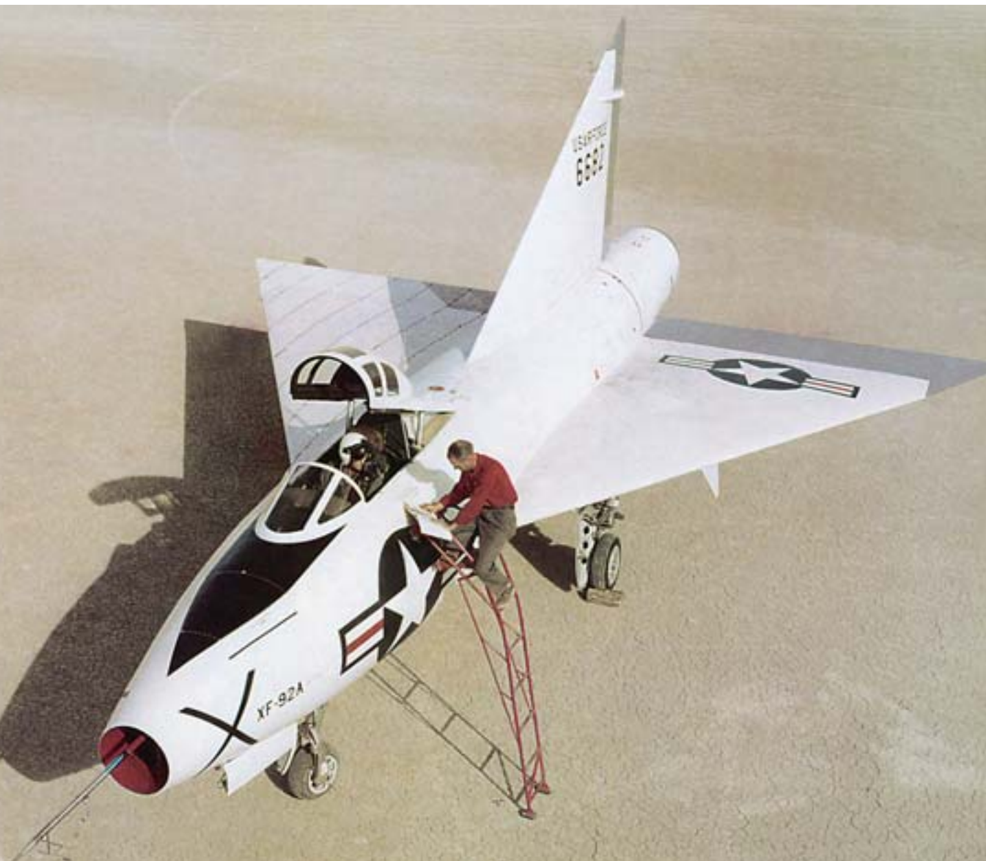
Первый в мире реактивный самолет с треугольным крылом XF-92A.
