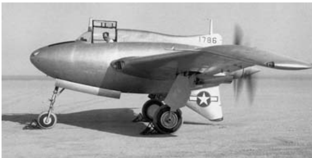
Первый экземпляр истребителя XP-56 перед полетом. В кабине — Джон Майерс.
