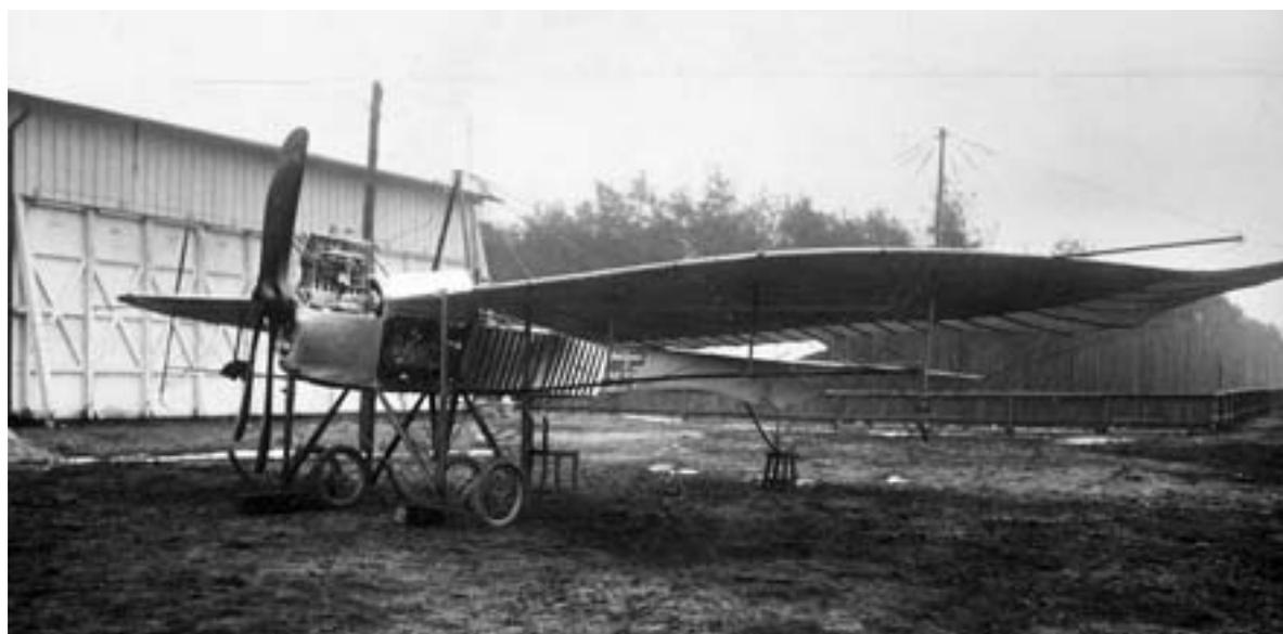
*Двухмоторный моноплан Луцкого с соосными винтами*
