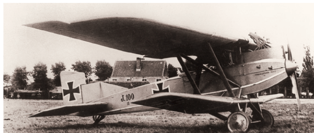
Штурмовик Юнкерс J.4 – первый самолёт дюралюминиевой конструкции
