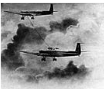
Метод передачи горючего в полёте по предложению П.И. Гроховского
