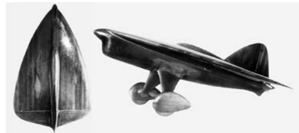
Продувочная модель самолёта «Стрела»
