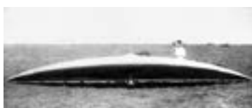
Планер БИЧ-2 имел увеличенный размах крыла и вертикальное оперение
