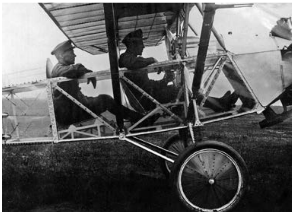
Благодаря прозрачной обшивке экипаж имел превосходный обзор вниз
