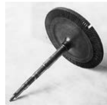
Турбина компрессора с оборванной лопаткой
