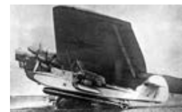
Телепланер (планторпеда) под крылом ТБ-3. Идея телепланера-торпеды принадлежала инженеру Комиссии морских минных опытов С.Ф. Валку, планеры изготовили на авиазаводе № 23 в Ленинграде
