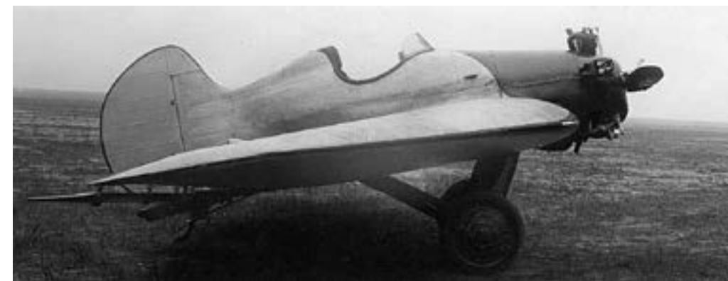
БОК-5 с удлиненным фюзеляжем на государственных испытаниях 1938 г.
