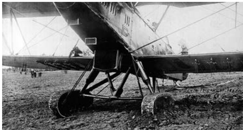
Испытания Р-5 с усовершенствованным гусеничным шасси, 1938 г.
