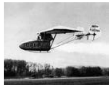
Полет ракетоплана фон Опеля с пороховыми ракетными двигателями 30 сентября 1929 г.
