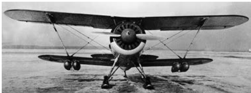
Истребитель И-15 бис с подвесными топливными баками конструкции Запанованного, 1939 г.
