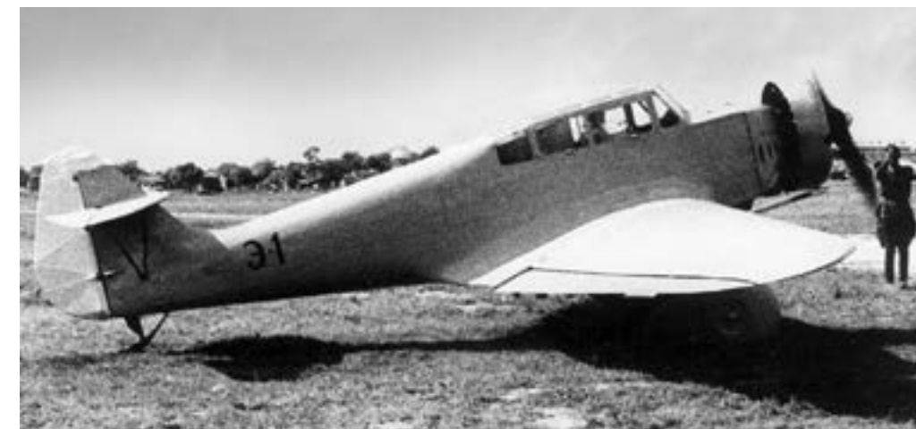
Э-1 с закрытым капотом двигателем, 1937 г.
