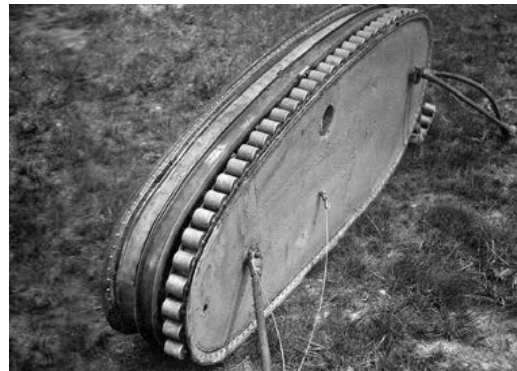
Конструкция шасси самолета П-5 со снятой гусеницей
