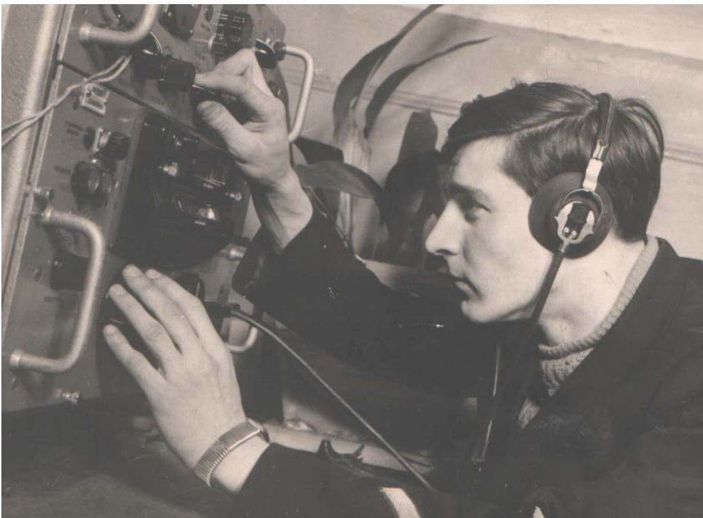
Евгений Михайлович Гришин проводит практическое занятие по приёму телефонных и телеграфных сигналов с борта воздушного судна на коротковолновый радиоприёмник Р-250. Лаборатория кафедры воздушной навигации Высшего авиационного училища ГВФ. 1965 год.
